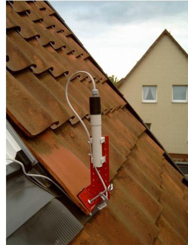
*Abbildung 4: Eigenentwicklung eines prototypischen Sensors zur Messung von Lufttemperatur, -feuchte und -druck*
